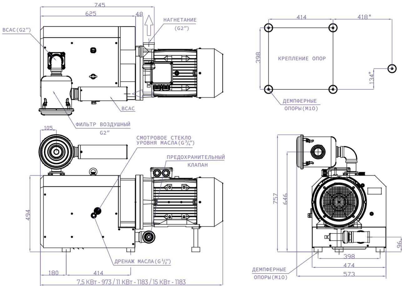
Все размеры на чертежах указаны в мм. \* Дополнительная опора электродвигателя 11 кВт, 15 кВт.
