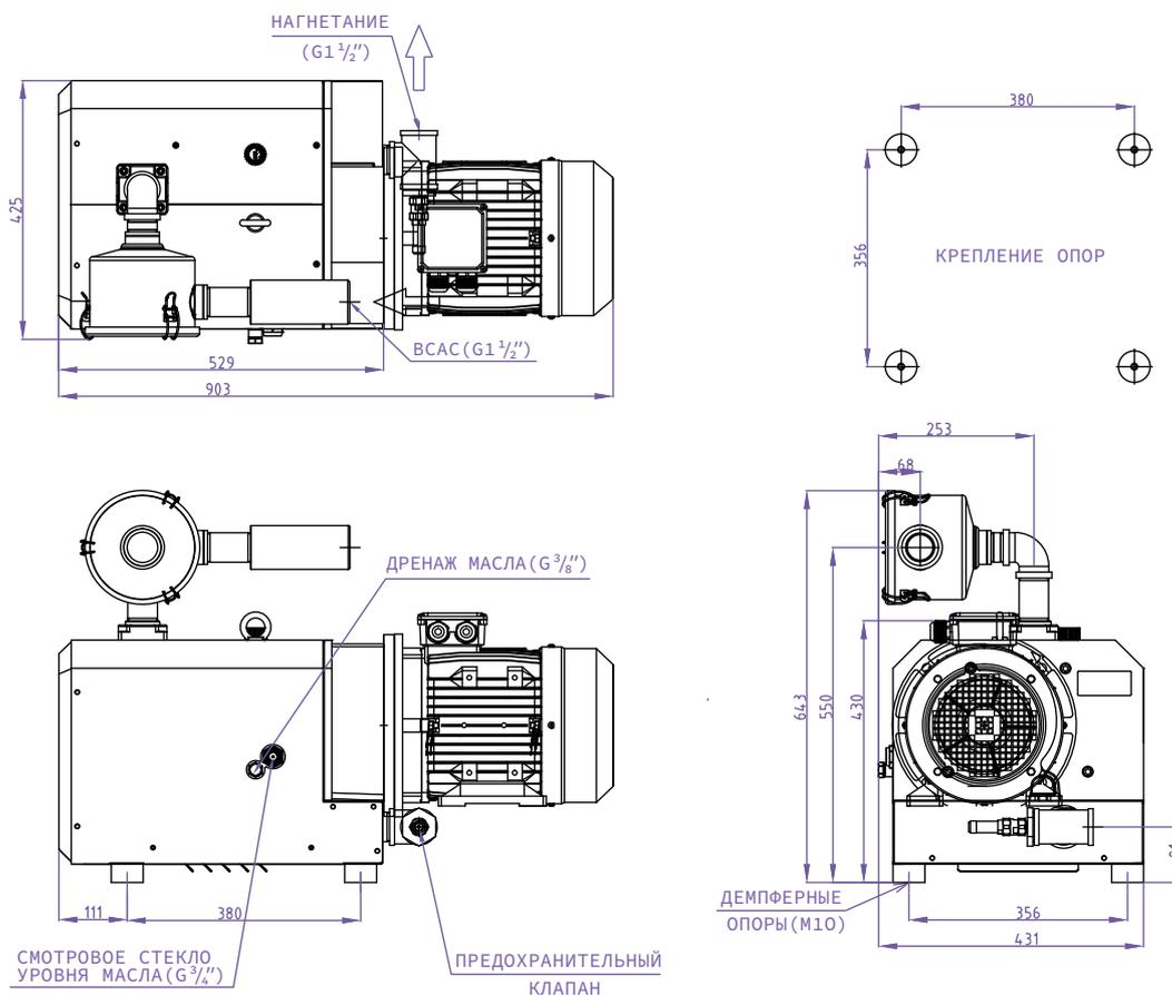
Все размеры на чертежах указаны в мм.
